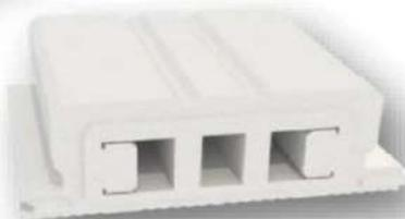
Il vespaio areato (100cm) sarà eseguito con solaio SPEEDY isolato 4bau 8/10/6f (h=20+4 ca) con idonee bocchette di areazione poste in corrispondenza dei muri perimetrali.
